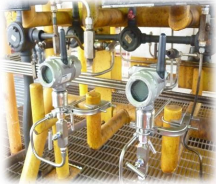
Monitoreo de Presión en bajantes de Pozos. Caan A, Abkatun Pol Chuc
